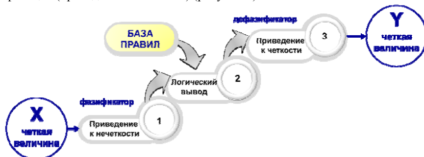
Рисунок 1. Механизм нечеткого логического вывода параметров
